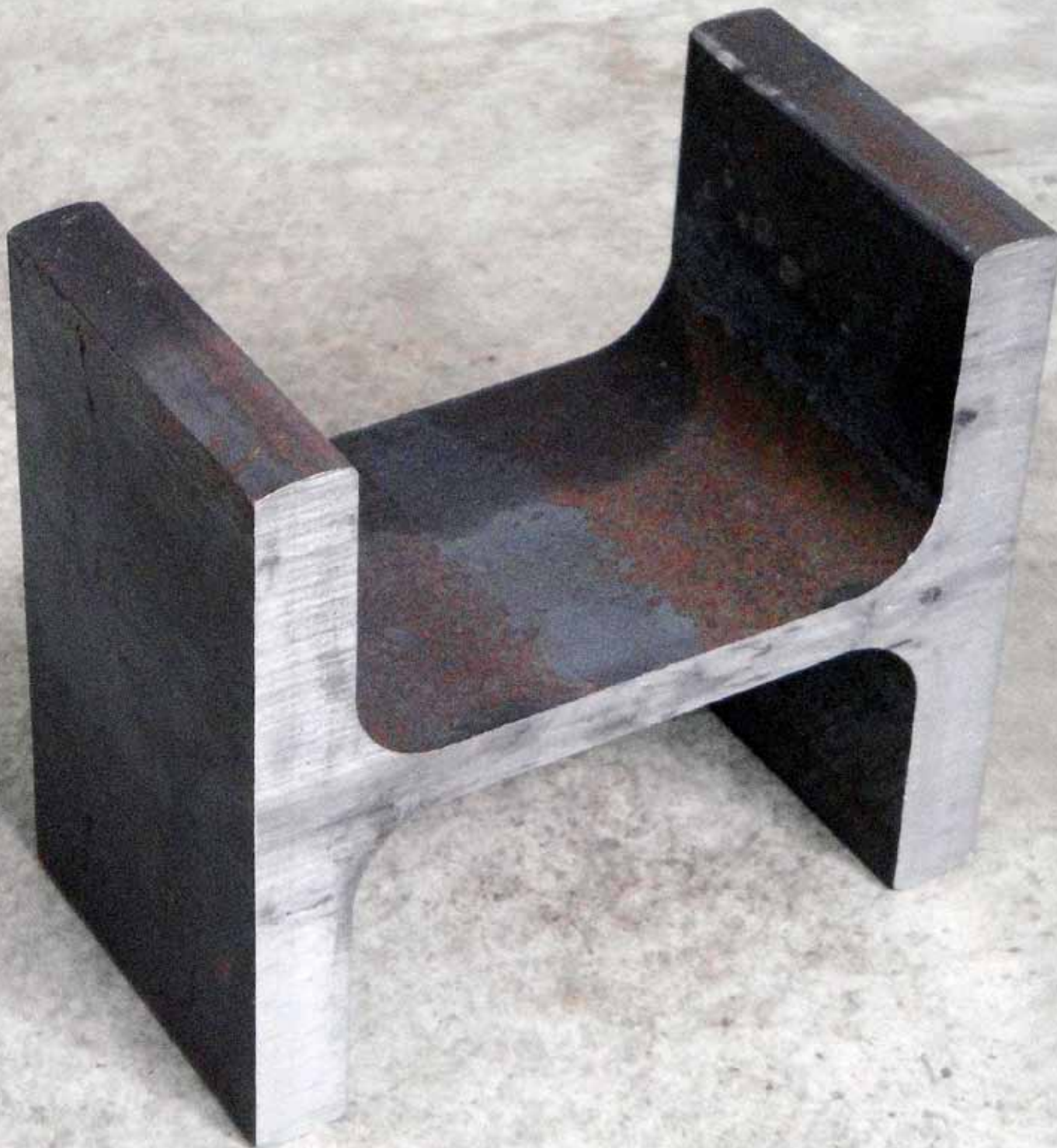
Materialmuster: Breitflanschträger, Bezeichnung: HEM 160
